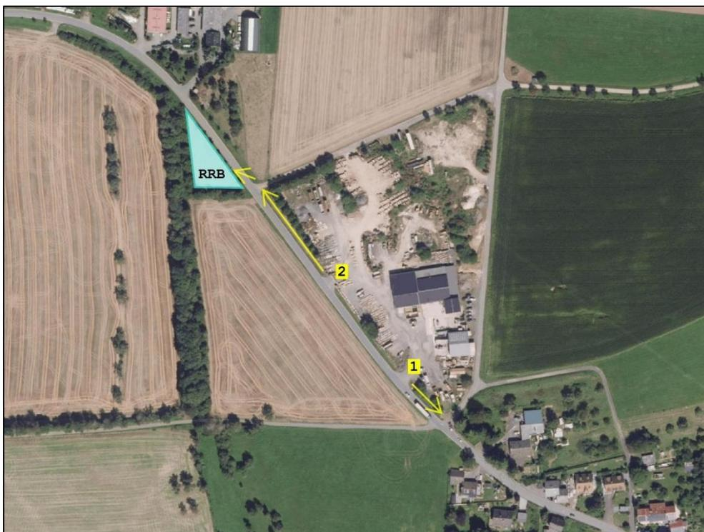
Abbildung 50: Mögliche Fließwege im Bereich der Gewerbefläche
