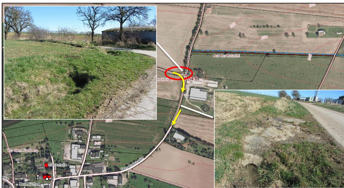
Abbildung 59: Engstellen im Entwässerungsgraben „In den Breitfelder“ und an der Donatusstraße
